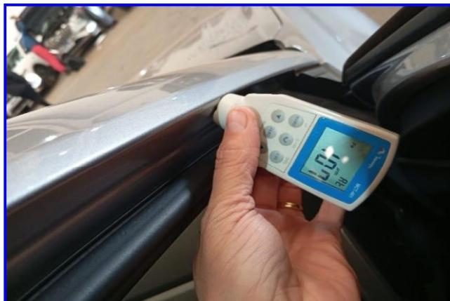
COLUNA TRASEIRA DIREITA 122 MICRONS
