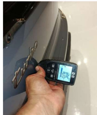
ANALISE PINTURA TAMPA TRASEIRA
