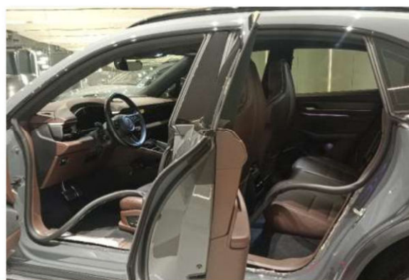
LATERAL ESQUERDA GUARNIÇÃO REMOVIDA
