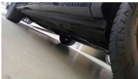
Caixa de ar lado esquerdo
