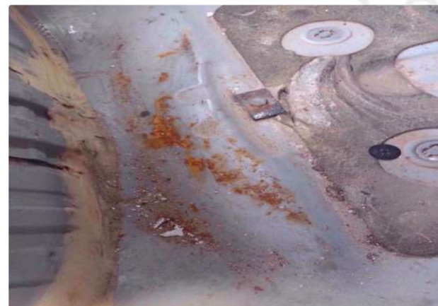
Assoalho do porta com oxidação e com furo do engate
