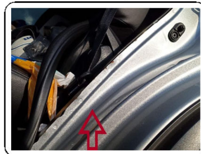
FOLHA DA COLUNA C ESQUERDA AVARIADA
