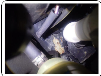
para-lama esquerdo início de corrosão
