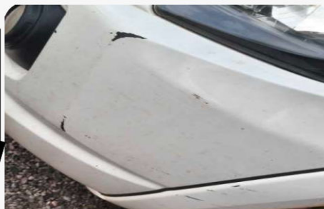
PARACHOQUE DIANTEIRO COM ARRANHÃO
