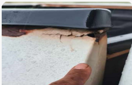
CARROCERIA DANIFICADA LADO DIREITO
