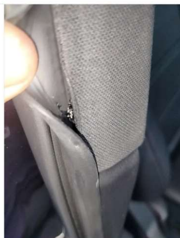
Pontos Robóticos - Colunas obstruída pela blindagem.
