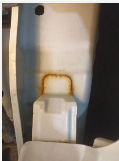
PONTOS DE OXIDAÇÃO
